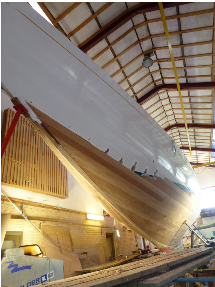
Die Planken wurden an den Übergängen zu den alten Planken 1:10 geschäftet und mit Epoxi geklebt.
