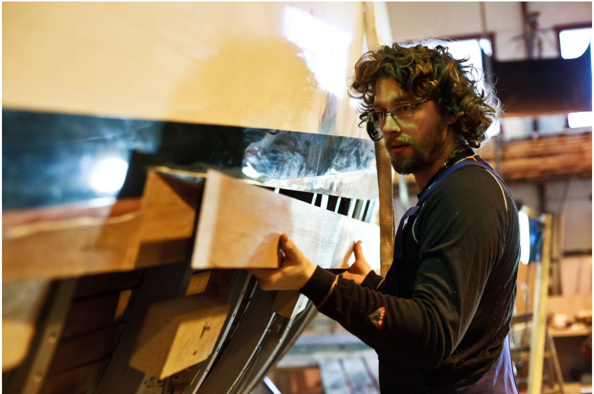
Die Planken wurden an den Übergängen zu den alten Planken 1:10 geschäftet und mit Epoxi geklebt.
